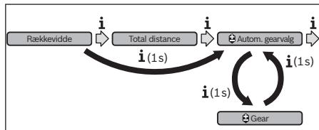
Ved at trykke på tasten „**i**“ i mere end 1 s kan du skifte frem og tilbage mellem den automatisk modus „**Autom. gearvalg**“ og den manuelle modus „**Gear**“.
