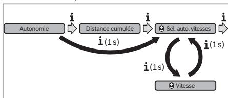
Un appui de plus d'1 s sur la touche « **i** » permet de passer du mode automatique « **Sél. auto. vitesses** » au mode manuel « **Vitesse** ».
