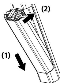
**2.1.6 Rimozione di una batteria integrata****1. Se è installato il coperchio in plastica amovibile della batteria, per prima cosa rimuoverlo dalla bicicletta.****2. Sbloccare la batteria.**
