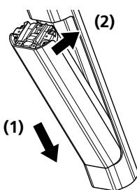
**2.1.6 Geïntegreerde accu uitnemen****1. Mocht er voor de accu nog een losse kunststof kap zitten, neem deze dan eerst uit de fiets.****2. Ontgrendel het accuslot.**
