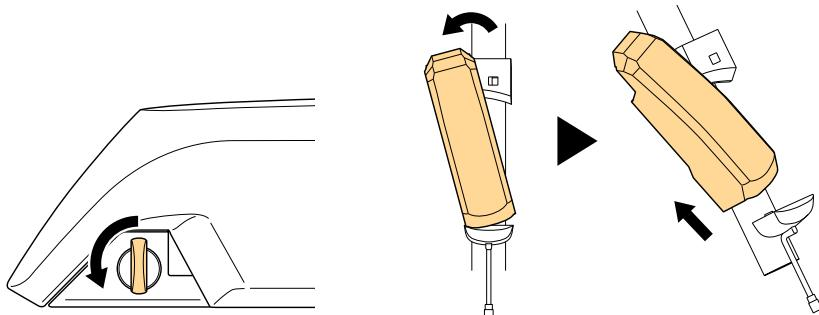
**2.1.5 Installazione di una batteria integrata****1. Eseguire la procedura descritta sotto per inserire la batteria dal basso.**
