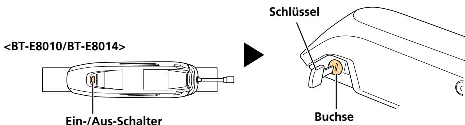
**2. Lösen Sie die Akku-Verriegelung.**
