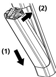
**2.1.6 Udtagning af indbygget batteri****1. Hvis cyklen er udstyret med et batteridækSEL, skal det afmonteres først.****2. Åbn batterilåsen.**
